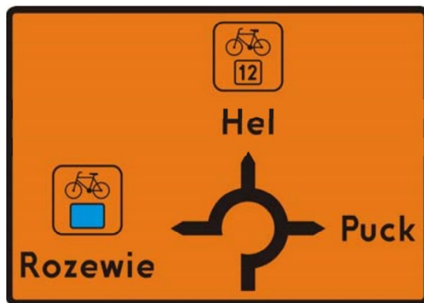
Rysunek 2: Znak R-4e tablica przeddrogowskazowa szlaku rowerowego.
