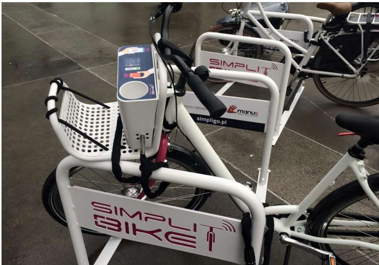
Ilustracja 19: Rower 4 generacji można przyłączyć do dowolnego stojaka za pomocą zintegrowanego z rowerem zapięcia sterowanego z komputera pokładowego (zdjęcie: SimpliBIKE).
